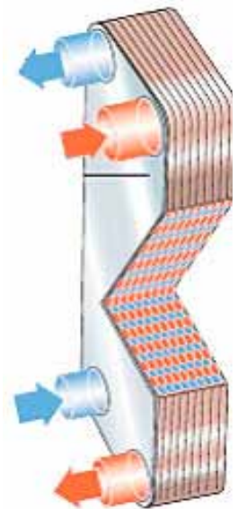
Рис. 2. Направления потока в паяном теплообменном аппарате
